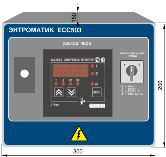
Рис. 21 Габаритные размеры, посадочные отверстия ECC503
